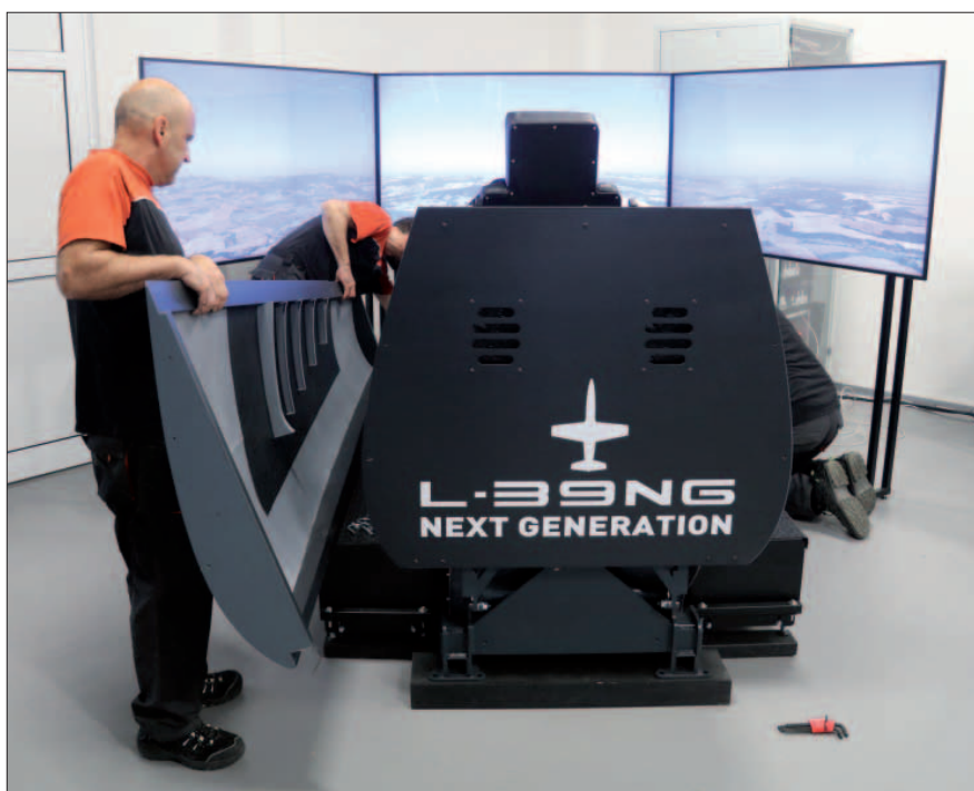
Díky demontovatelným bočním panelům má obsluha snadný přístup k elektronice simulátoru
