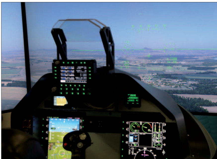
V základní konfiguraci jsou údaje HUD zobrazovány na vnější projekční ploše
